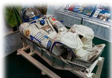
Аварийно-спасательный скафандр "Сокол" летчика-космонавта СССР В.П. Савиных. 1985 г. Предназначен для спасения космонавтов в случае разгерметизации космического корабля.
